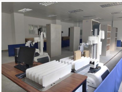
图 6-12 面向档案抓取的多移动协同机器人系统
