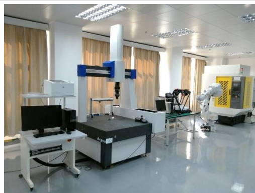
图 6-13 智能制造装配工艺工作站
